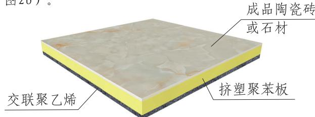
图2a 平头型FD保温隔声砖
