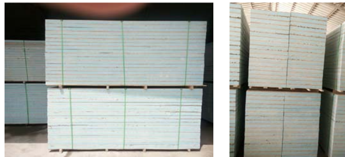
图7-1 TD保温结构一体化板堆放
