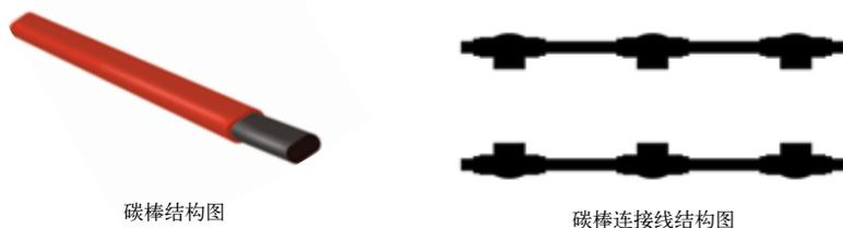
图2 碳棒及碳棒连接线示意图
