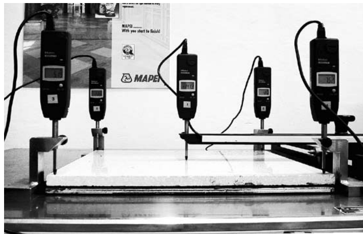
图5.2 马贝石材湿稳定性的粘结试验
