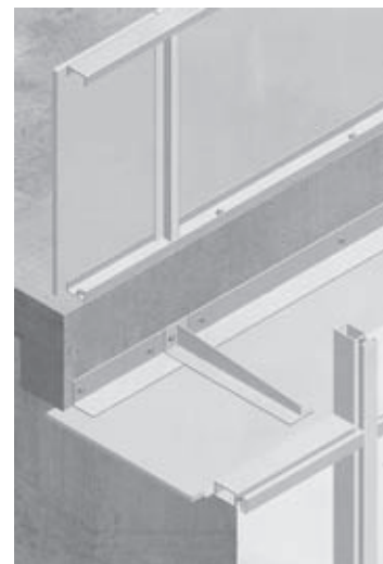
图 11 玻璃幕墙防火裙墙和层间封堵
