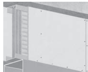
图 9 防火卷帘上部封堵
