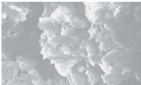
未经处理的混凝土(放大4000倍) 水、油和其他污垢通过混凝土或石造物的天然孔穴渗透到物体内部
